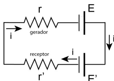
Perceba que a corrente elétrica tem sentido de (-) para (+) no gerador e de (+) para (-) no receptor. A ddp aplicada entre os terminais do receptor é a soma da fcem  $\mathcal{E}'$  com o
