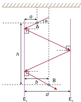
Determine o ângulo de incidência  $\alpha$ , em relação à horizontal, em função de  $a$ ,  $b$ ,  $d$  e  $h$ , para que um feixe de luz atravessa o anel A, reflita-se nos espelhos  $E_1$ ,  $E_2$  e  $E_1$  e atravessa o anel B, como indica o percurso na figura. Admita que os ângulos de incidência e de reflexão do feixe de luz sobre um espelho sejam iguais.
