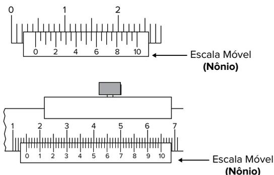
A resolução  $R$  de um paquímetro é dada pela razão entre o valor da menor divisão da escala fixa (UEF) pelo número de divisões do nônio (NDN). Um paquímetro que, por exemplo, tem sua escala fixa graduada em milímetros e cujo nônio tem 20 divisões é de 0,05 mm.
