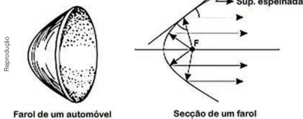
Esquema do funcionamento de um farol com a forma parabólica.
