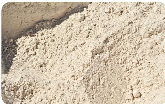
Óxido de cálcio separado para utilização como matéria prima na preparação de argamassa. Material base para a construção civil.
