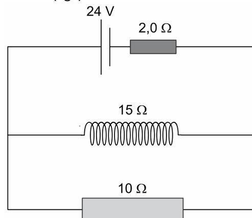
A figura representa um circuito em que consta um gerador de corrente contínua de força eletromotriz 24 V e resistência interna de  $2,0 \Omega$ . O gerador alimenta uma associação em paralelo de um resistor ôhmico de  $10 \Omega$  e um solenoide com certo comprimento e número de espiras, com resistência ôhmica de  $15 \Omega$ .
