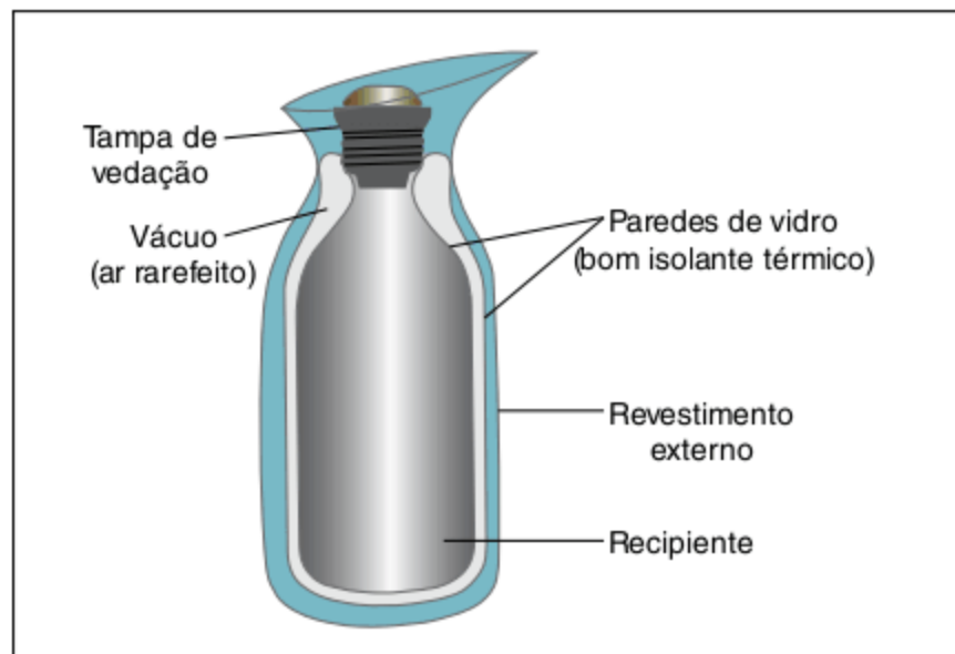
Fig. 19 Esquema de uma garrafa térmica.
