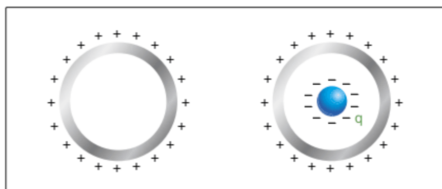
Fig. 33 Condutor esférico carregado positivamente com uma carga negativa introduzida no seu interior.
