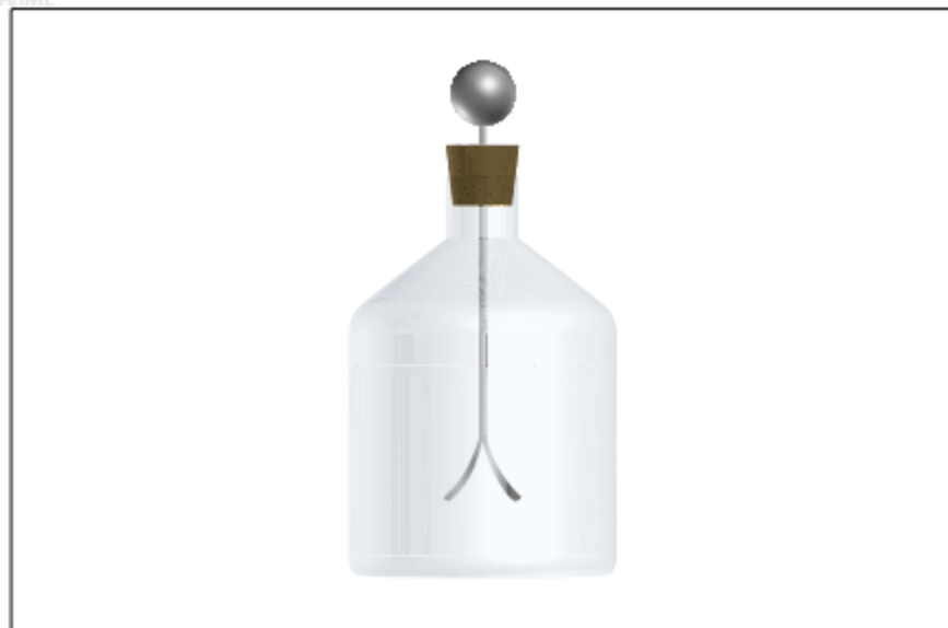
Fig. 39 Eletroscópio de folhas.
