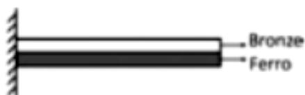
Nessa situação, a lâmina está plana e horizontal. A seguir, ela é aquecida por uma chama de gás. Após algum tempo de aquecimento, a forma assumida pela lâmina será mais adequadamente representada pela figura:
