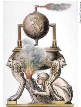
A figura acima é uma gravura do século XIX que mostra o "motor" inventado por Heron de Alexandria, a eolípila. Essa é a primeira "máquina a vapor" de que se tem notícia. (Coleção particular.)
