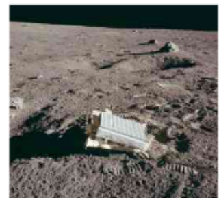
Refletor lunar de feixes laser deixado no solo da Lua. Ele é formado por células prismáticas dispostas lado a lado.
