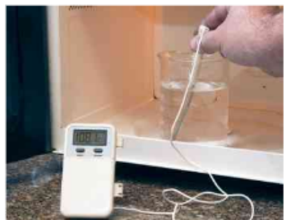
Nesta fotografia observamos água destilada superaquecida. A temperatura registrada no termômetro foi obtida aquecendo-se a água em um forno de micro-ondas sem o prato giratório.
