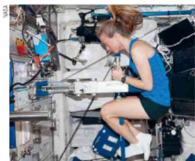
Body Mass Measuring Device (BMMD), aparelho em forma de cadeira projetado por engenheiros da NASA para monitorar as perdas de massa corpórea dos astronautas. Nesta fotografia, a astronauta Karen Nyberg realiza atividades de monitoramento e medição de massa.
