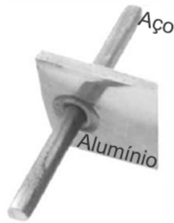
O valor do coeficiente de dilatação do alumínio é, aproximadamente, duas vezes o valor do coeficiente de dilatação térmica do aço. Aquecendo-se o conjunto a  $200 \text{ }^\circ\text{C}$ , é correto afirmar que:
