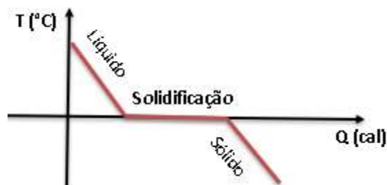
Figura 9: Curva de aquecimento para solidificação.
