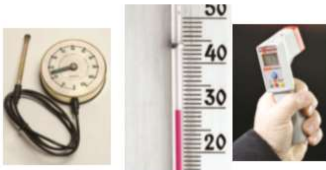
Figura 2: Da esquerda para a direita: Termômetro de gás, termômetro de mercúrio e termômetro digital.
