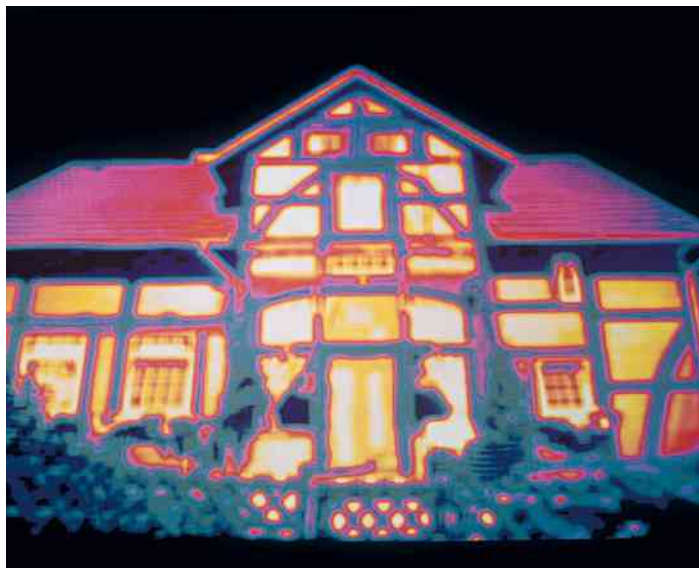
Figura 1.30 Fotografia em infravermelho de uma casa.
