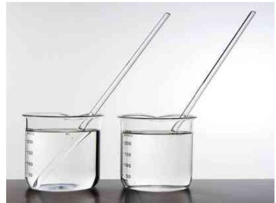
Figura 9.8 Quando um bastão de vidro é mergulhado em um líquido de índice de refração idêntico ao seu (tetracloretileno), ele fica invisível.
