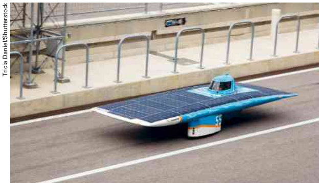
Figura 5.9 Carro elétrico alimentado por energia solar, que é captada por meio das células fotovoltaicas instaladas sobre o teto do veículo. Competição de carros movidos a energia solar. Austin, Texas (EUA), 2014.
