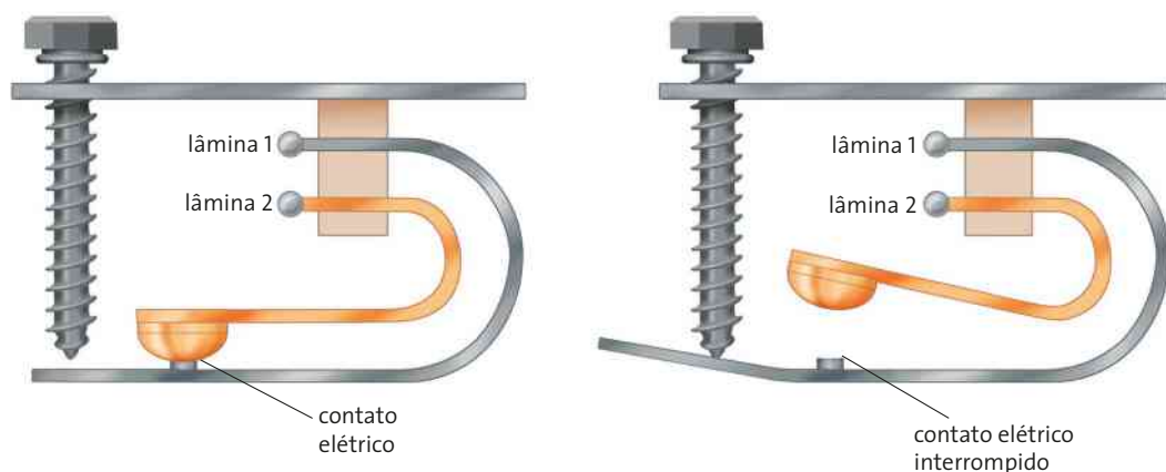
Figura 1.17 Lâminas bimetálicas interrompendo um contato elétrico ao se aquecerem. Representação sem escala e em cores fantasia.
