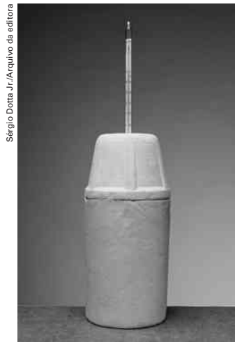
Calorímetro simples: copo térmico, de poliestireno expandido, com tampa e termômetro.
