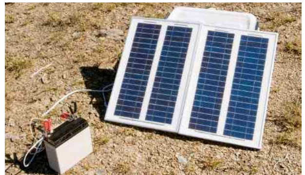
Figura 5.10 Representação do uso de células fotovoltaicas para carregar baterias, visando a iluminação doméstica.
