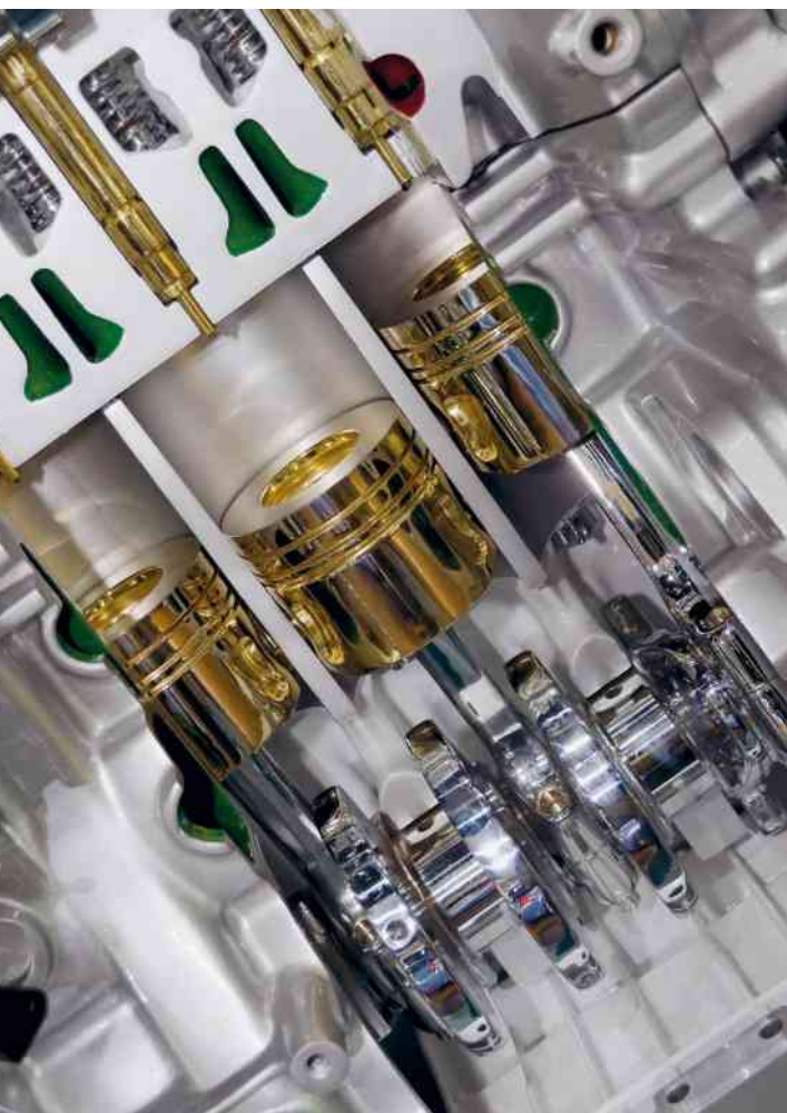
Figura 4.12 Dois cilindros de um motor 1.0 de 4 cilindros em linha, com 56,6 kW (77 cv). O volume aspirado por cilindro é 0,25 L.
