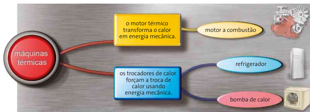
Figura 4.3 Classificação das máquinas térmicas. Representações sem escala e em cores fantasia.
