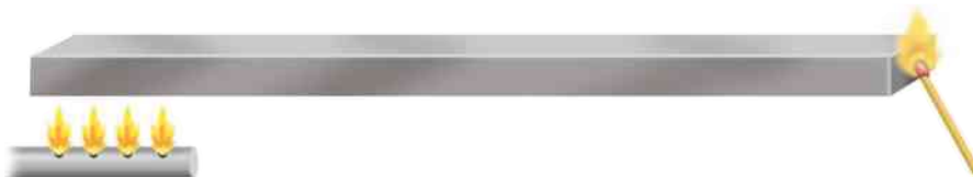
Figura 1.22 O fósforo é aceso através do calor transmitido pela barra. Representação sem escala e em cores fantasia.
