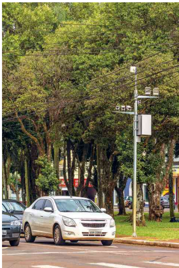
Figura 7.37 Os radares são instrumentos que utilizam o efeito Doppler para medir a velocidade dos automóveis. Radar fotográfico para fiscalização de velocidade. Cascavel (PR), 2015.
