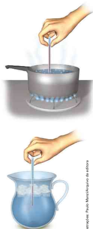
Figura 1.3 Pontos fixos da água: os estados térmicos para calibragem da escala termométrica. Representações sem escala e em cores fantasia.
