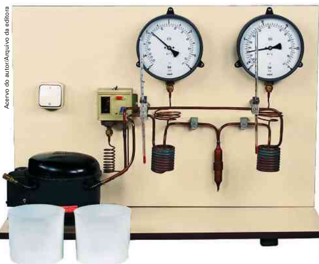
Figura 4.6 Dispositivo experimental para determinar a eficiência de um trocador de calor com base nas leituras das temperaturas.
