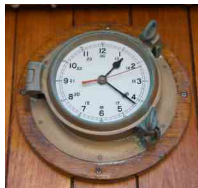
Figura 6.7 Como no sistema massa-mola a aceleração da gravidade não influencia no período, a aplicação desse tipo de sistema em relógios nos transportes sujeitos a balanços substituiu os de pêndulo.
