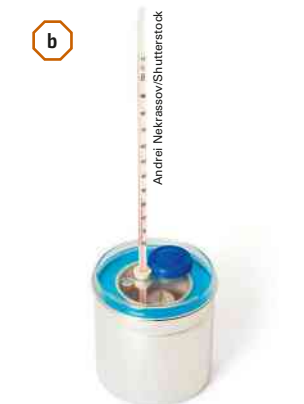
Figura 2.14 (a) Calorímetro simples: copo térmico, de poliestireno expandido, com tampa e termômetro. (b) Calorímetro mais preciso.
