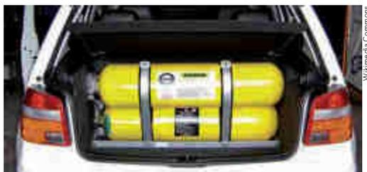
Veículo equipado com cilindros de gás natural.
