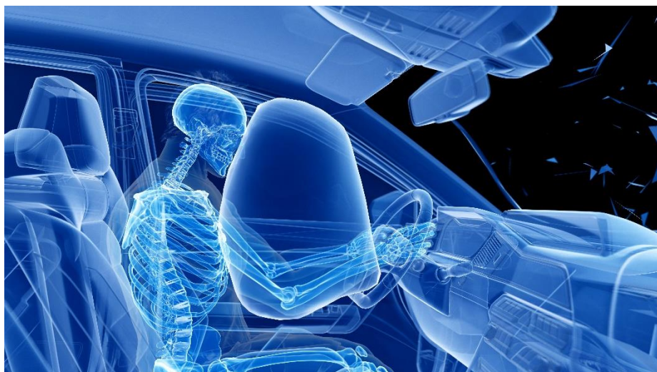
Figura 71: O airbag é um dispositivo que se baseia na conversão de azida de sódio em gás nitrogênio
