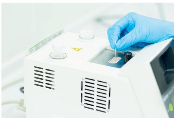
Equipamento laboratorial para determinação de ponto de fusão
