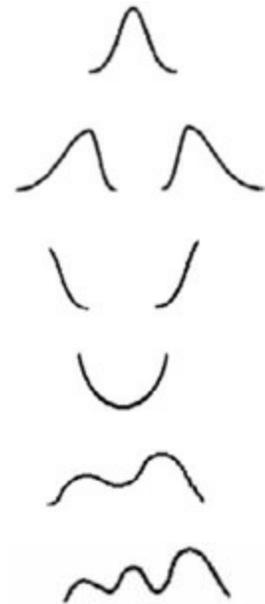
**Figura 2-4:** Exemplos de curvas de frequência interpretáveis a partir de um histograma
