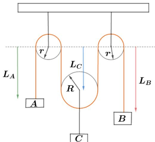
Figura 21: Exemplo de aplicação de vínculos geométricos em polia móvel.
