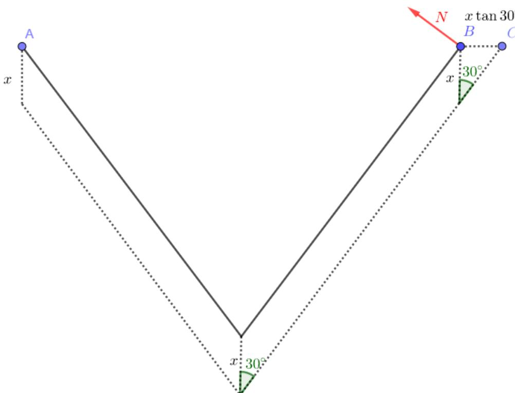
$A$  e  $B$  são os pontos de contato no momento inicial. Como o sistema é simétrico, usaremos somente um lado dele, assim foi representado o ponto de contato no momento subsequente somente do lado direito, o qual foi denominado  $C$ . Note que o ponto de contato sempre mantém a altura. Pela relação de deslocamento entre o bloco e o prisma, temos:
