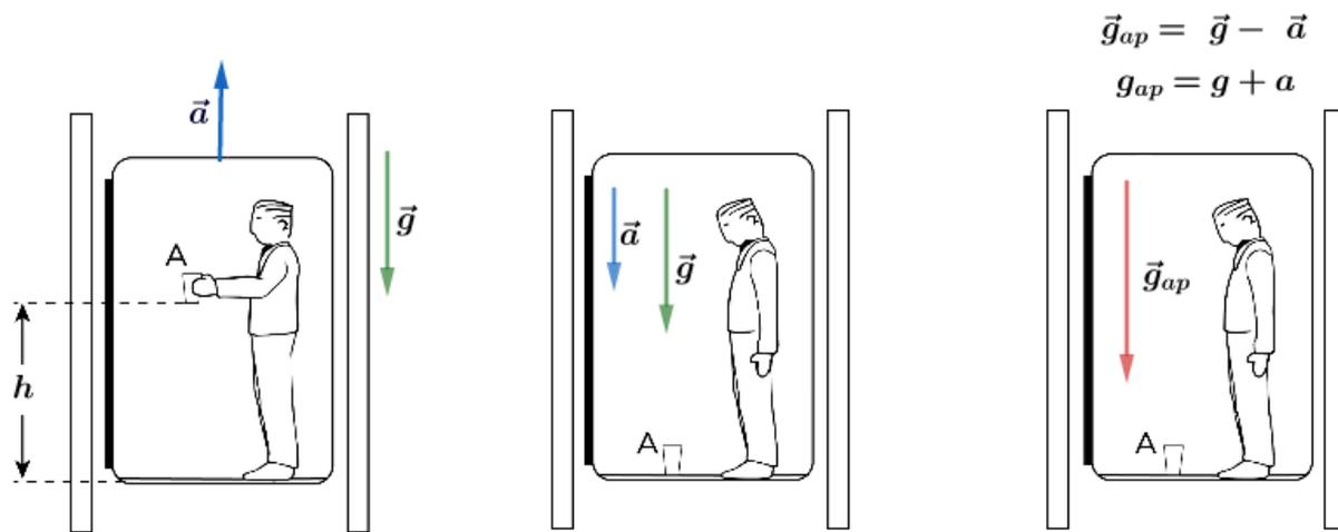
Figura 25: Uso de gravidade aparente para resolução de problemas no elevador acelerado.
