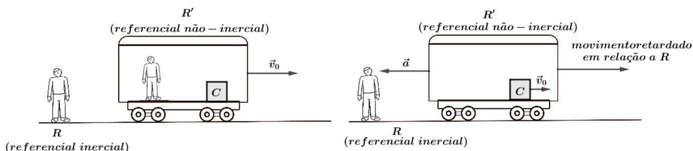
Figura 24: Movimento do caixote observado de um referencial inercial R e um referencial não-inercial R'.
