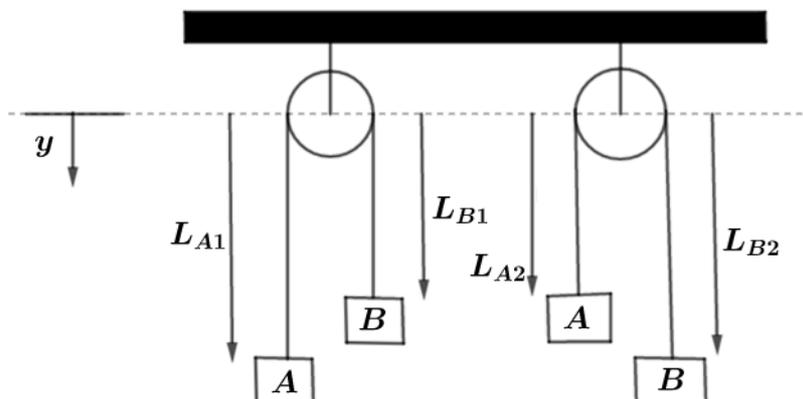
Figura 20: Exemplo de aplicação de vínculos geométricos em polias fixas.
