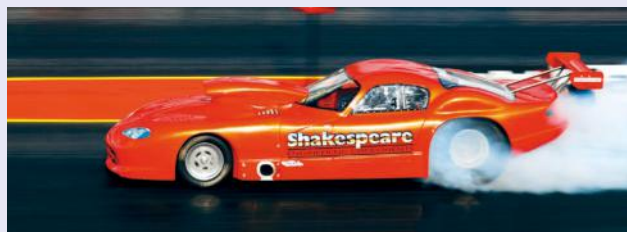
// Largada com o veículo “cantando os pneus”: desperdício de potência e aceleração com intensidade menor que a máxima possível.
