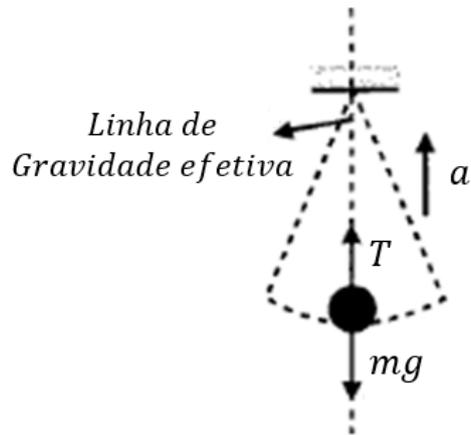
Figura 13: Diagrama de corpo livre em um pêndulo simples.
