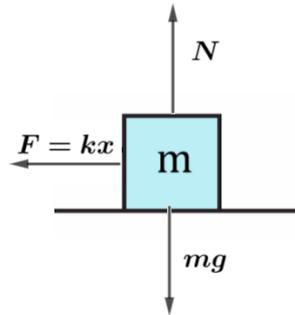
Figura 5: Diagrama de corpo livre no bloco.
