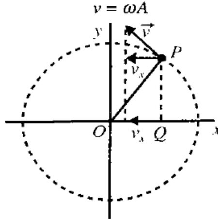
Figura 7: Objeto deslocando com velocidade angular constante em um movimento circular.
