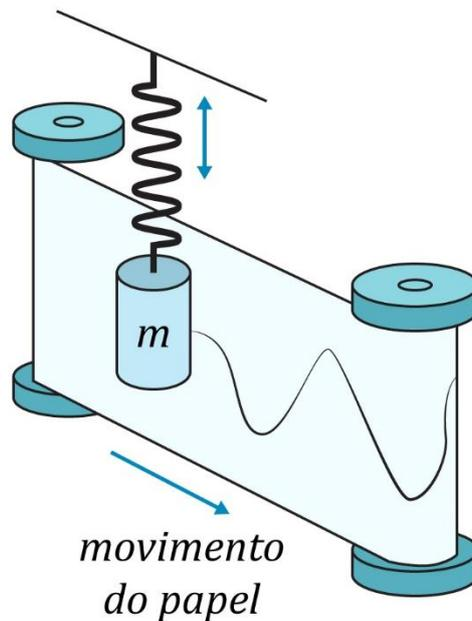
Figura 2: Representação esquemática de um MHS. A medida que o corpo de massa  $m$  oscila na vertical, o papel se movimenta na horizontal descrevendo como varia a posição do corpo em função do tempo.
