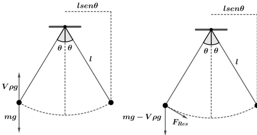
Figura 17: Pêndulo simples no interior de um líquido.
