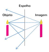
Os raios, então, divergem a partir do espelho e parecem emanar de um ponto particular situado atrás do espelho (onde se interceptam as linhas tracejadas). Um observador enxerga a imagem da chama como estando neste ponto. Mas os raios de luz não provêm realmente deste ponto, razão pela qual a imagem é denominada uma imagem virtual.
