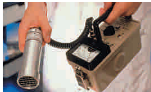
O contador Geiger é de extrema importância para medir a radioatividade absorvida pelas pessoas.
