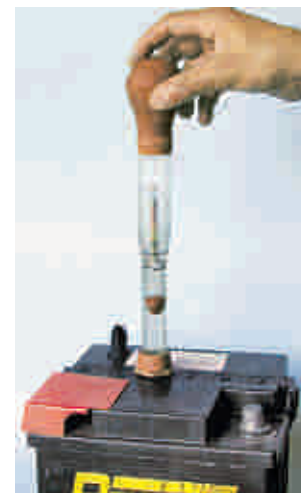
À esquerda, representação esquemática do densímetro utilizado para testar a carga da bateria. À direita, vemos o densímetro sendo utilizado.
