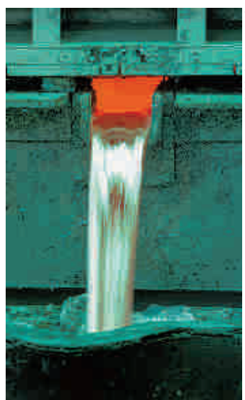
Alumínio fundido escorre para o molde em uma indústria em São Paulo, SP.
