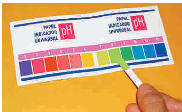
Escala do papel indicador universal mostrando as cores correspondentes às variações de pH.
