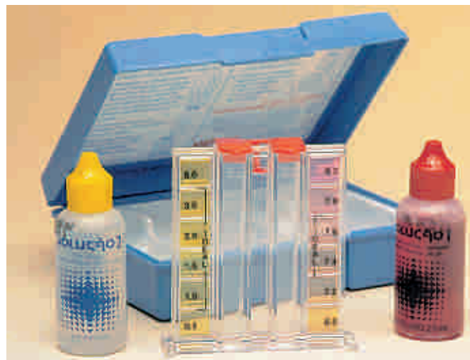
Kit utilizado para medir o pH e a concentração de cloro em piscinas.
