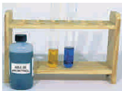
O azul de bromotimol é amarelo em pH = 4 (tubo à esquerda); em pH = 8 é azul (à direita).
