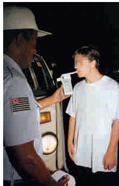
O bafômetro mede a concentração de álcool no sangue por meio do ar expirado.
