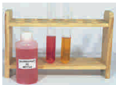
O alaranjado de metila é vermelho em pH = 2 (tubo à esquerda); em pH = 7 é alaranjado (à direita).
