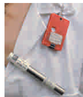
Dosímetro usado pelos operadores de material radioativo. É um alerta contra exposições perigosas.
