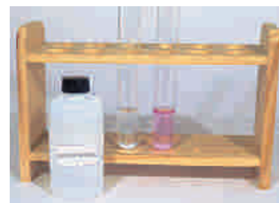
A fenolftaleína é incolor em pH = 6 (tubo à esquerda); em pH = 10 é rósea (à direita).
