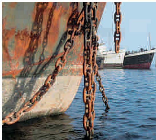
Quando não recebem pinturas freqüentes, os cascos dos navios são rapidamente corroídos pela ferrugem.
