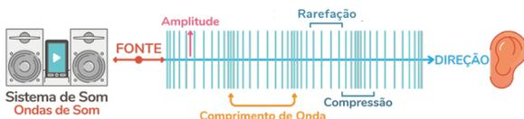
Esse tipo de onda é também chamada de onda de compressão, pois ela se transmite produzindo zonas de compressão e zonas de rarefação:
