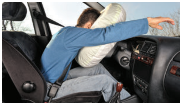
O airbag amortece o impacto, aumentando o tempo de interação entre o ocupante e o volante do veículo.
