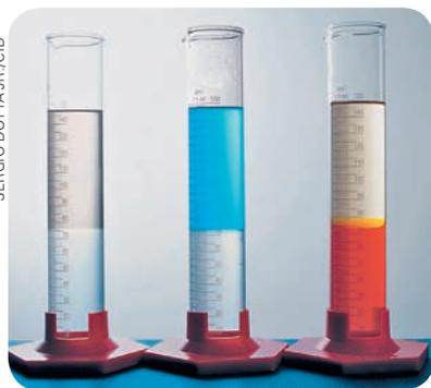
▲ Nas três provetas, a fase superior é água ( $\text{H}_2\text{O}$ , polar) e a inferior é tetracloreto de carbono ( $\text{CCl}_4$ , apolar). Na proveta do centro foi adicionado sulfato de cobre ( $\text{CuSO}_4$ , composto iônico), que se dissolve preferencialmente na fase polar, dando-lhe a cor azul. Na proveta da direita foi colocado bromo ( $\text{Br}_2$ , apolar), que se dissolve preferencialmente na fase apolar, conferindo-lhe a cor alaranjada.
