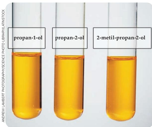
▲ Em três tubos com  $\text{K}_2\text{Cr}_2\text{O}_7/\text{H}^+$  serão adicionados os álcoois indicados.
