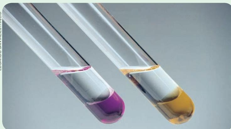
▲ O tubo da esquerda mostra uma fase superior de ciclo-hexano e uma fase inferior de  $\text{KMnO}_4$ . Como o composto orgânico é saturado, não ocorre descoloramento da cor violeta do permanganato. No tubo da direita, permanganato foi misturado com hex-1-eno, havendo desaparecimento da cor violeta graças à oxidação da ligação dupla. O material ocre resultante é o produto da redução do manganês.
