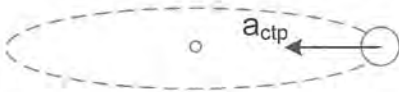
Figura 102 – no referencial inercial da Terra, o pêndulo está se movendo em MCU animado de aceleração centrípeta a_{ctp} .
