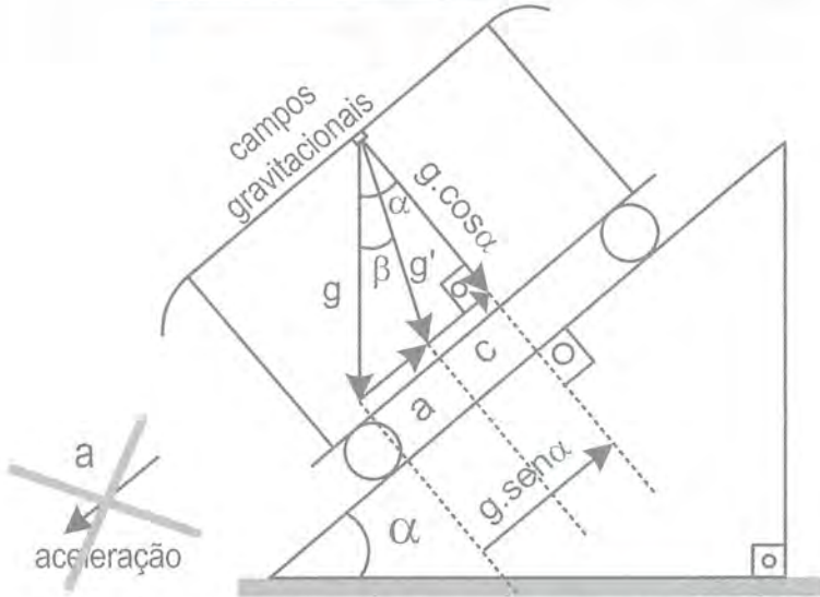
Figura 92 – Diagrama das forças que agem na cunha, no referencial acelerado
