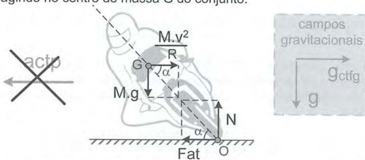
Figura 113 – Diagrama das forças que agem no conjunto moto+motoqueiro no referencial não inercial em rotação
