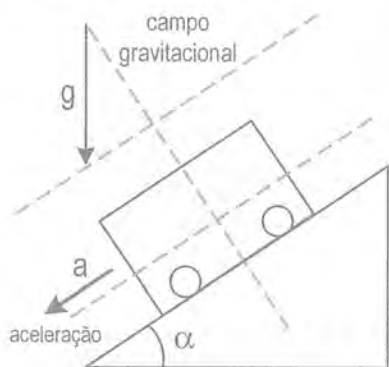
Figura 88 – Diagrama das forças que agem na cunha, no referencial acelerado
