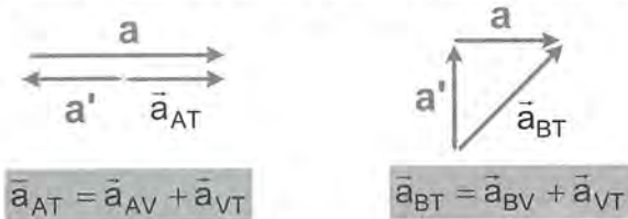
Figura 66 - aceleração de A e B, em relação à Terra, e suas componentes
