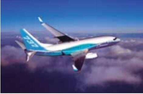
Tomando como base um Boeing 737-800, seus tanques de combustível podem comportar até 21 t (21 toneladas) de querosene de aviação (QAV).
