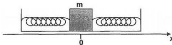
A figura acima mostra duas molas ideais idênticas presas a um bloco de massa  $m$  e a dois suportes fixos. Esse bloco está apoiado sobre uma superfície horizontal sem atrito e oscila com amplitude  $A$  em torno da posição de equilíbrio  $x=0$ . Considere duas posições do bloco sobre o eixo  $x$ :  $x_1 = A/4$  e  $x_2 = 3A/4$ . Sendo  $v_1$  e  $v_2$  as respectivas velocidades do bloco nas posições  $x_1$  e  $x_2$ , a razão entre os módulos das velocidades,  $v_1/v_2$ , é
