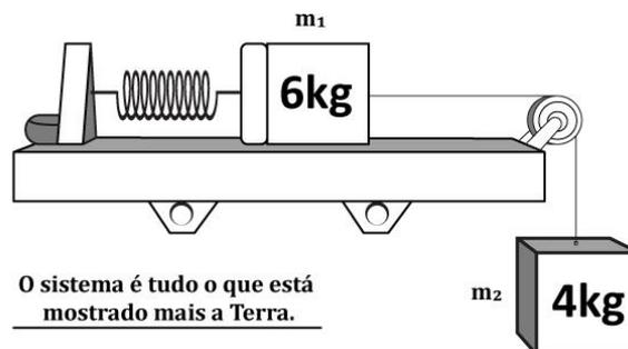
Figura 32: Representação de dois blocos ligados por um fio, com movimentos na horizontal e na vertical devido ao emprego de uma polia.
