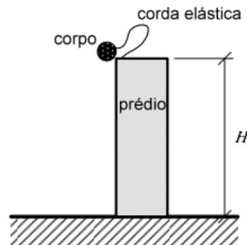
Um corpo preso a uma corda elástica é abandonado em queda livre do topo de um edifício, conforme apresentado na figura acima. Ao atingir o solo, penetra numa distância  $x$  abaixo do nível do solo até atingir o repouso. Diante do exposto, a força de resistência média que o solo exerce sobre o corpo é:
