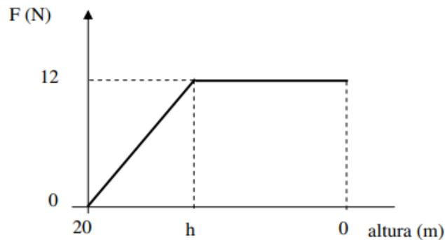
Um objeto com massa de  $1 \text{ kg}$  é largado de uma altura de  $20 \text{ m}$  e atinge o solo com velocidade de  $10 \text{ m/s}$ . Sabe-se que a força  $F$  de resistência do ar que atua sobre o objeto varia com a altura, conforme o gráfico acima. Considerando que  $g = 10 \text{ m/s}^2$ , a altura  $h$ , em metros, em que a força de resistência do ar passa a ser constante é
