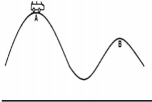
Em uma montanha russa, um carrinho com massa de  $200 \text{ kg}$  passa pelo ponto A, que possui altura de  $50 \text{ m}$  em relação à linha horizontal de referência, com velocidade de  $43,2 \text{ km/h}$ . Considerando que não há atrito e que  $g = 10 \text{ m/s}^2$ , a velocidade com que o carrinho passa pelo ponto B, que possui altura de  $37,2 \text{ m}$  em relação à linha horizontal de referência, é de aproximadamente:
