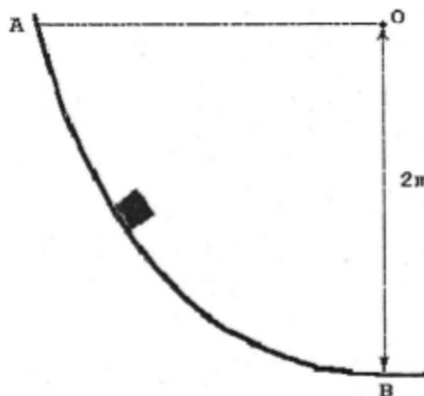
Na figura acima o bloco de massa  $30 \text{ kg}$ , que é abandonado do ponto A com velocidade zero, desliza sobre a pista AB. Considere que ao longo do percurso a força de atrito entre o bloco e a pista dissipa  $60 \text{ J}$  de energia. A velocidade do bloco no ponto B, em  $\text{m/s}$ , é Dado:  $g = 10 \text{ m/s}^2$ .
