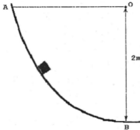
Na figura acima o bloco de massa 30 kg, que é abandonado do ponto A com velocidade zero, desliza sobre a pista AB. Considere que ao longo do percurso a força de atrito entre o bloco e a pista dissipa 60 J de energia. A velocidade do bloco no ponto B, em  $m/s$ , é Dado:  $g = 10 m/s^2$ .
