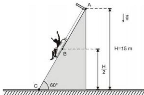
Essa “partícula” inicia seu movimento do repouso, no ponto A, situado a uma altura  $H=15$  m, escorregando ao longo do tobogã que está inclinado de  $60^\circ$  em relação ao solo, plano e horizontal.
