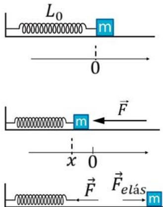
Figura 10: Quando a mola está relaxada, ela não exerce força sobre o bloco. Ao ser comprimida, de modo que  $x$  é negativo, ela exerce uma força de magnitude  $-k \cdot x$ , de modo que  $x$  é negativo, portanto,  $-k \cdot x$  é positivo.
