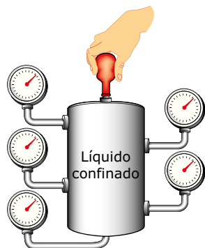
Figura 1. O aumento de pressão exercida sobre a superfície do líquido é transmitido a todos os outros pontos do líquido.
