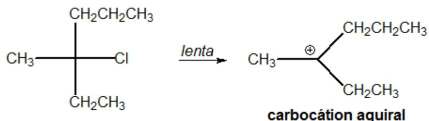
Figura 65: Formação do Carbocátion Aquiral nas Reações SN1
