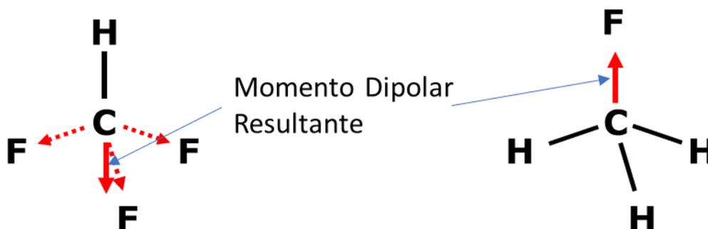
Figura 57: Polaridade no  $\text{CH}_3\text{F}$  e no  $\text{CH}_2\text{F}_2$
