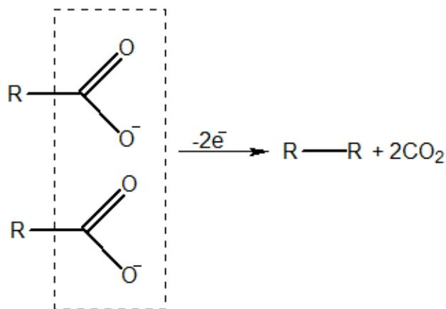
Figura 44: Esquema Geral da Síntese de Kolbe
