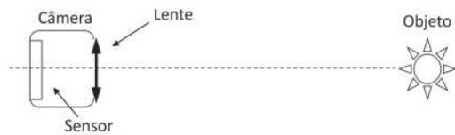
Em uma câmera digital que utilize uma lente convergente com 20 mm de distância focal, a distância, em mm, entre a lente e o sensor da câmera, quando um objeto a 2 m estiver corretamente focalizado, é, aproximadamente,
