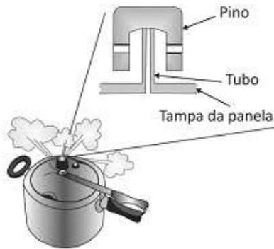
Na situação em que apenas a força gravitacional, a pressão atmosférica e a exercida pelos gases na panela atuam no pino, a pressão absoluta máxima no interior da panela é
