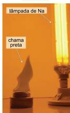
(II) Chama na presença de solução de NaCl, irradiada com lâmpada de Na.
