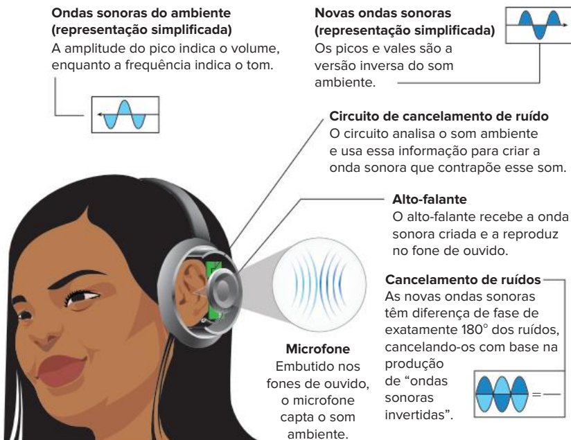
Esquema explicativo simplificado do funcionamento dos fones com cancelamento eletrônico de ruídos por interferência destrutiva.
