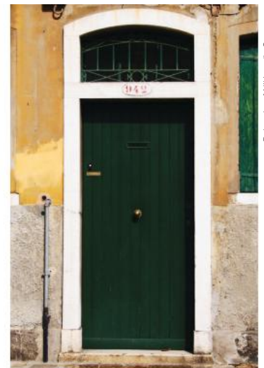
Será que é eficiente posicionar a maçaneta no meio de uma porta? Nesse caso, para abri-la é necessária a aplicação de uma força maior do que se a maçaneta fosse posicionada na extremidade oposta às dobradiças.
