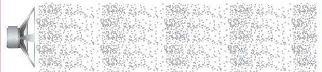
Representação de ondas sonoras se propagando no ar. Os pontos escuros representam partículas do meio que oscilam para frente e para trás, enquanto a perturbação se propaga na direção horizontal.
