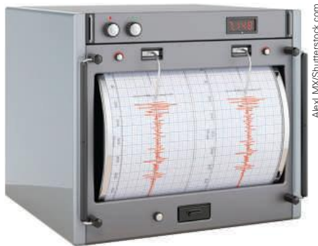
O sismógrafo pode detectar e registrar vibrações naturais ou provocadas pelos seres humanos.
