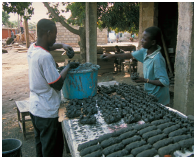
Ferreiros trabalhando em moldes de barro para produzir peças metálicas utilizando a técnica da cera perdida.
