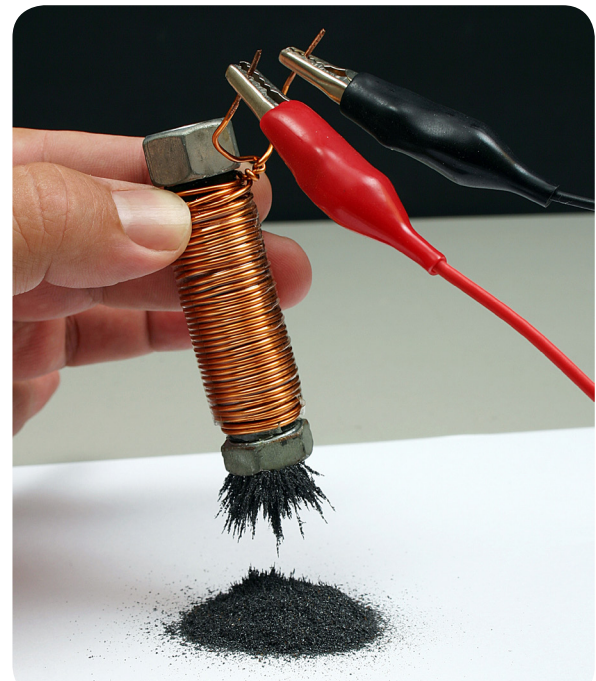
Representação de um eletroímã. Quando uma corrente percorre a bobina, a estrutura é magnetizada, atraindo as limalhas de ferro.
