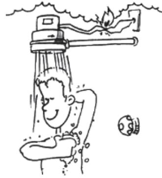
O superaquecimento da fiação, devido a esse aumento da corrente elétrica, pode ocasionar incêndios, que seriam evitados instalando-se fusíveis e disjuntores que interrompem essa corrente, quando a mesma atinge um valor acima do especificado nesses dispositivos de proteção.
