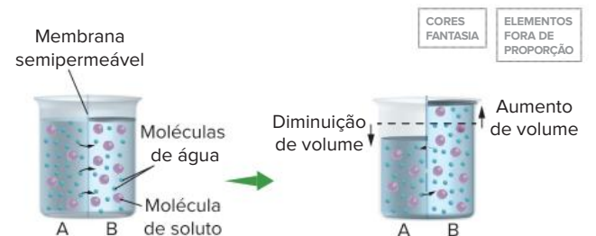
Duas soluções, A (hipotônica com relação a B) e B (hipertônica em relação a A), são separadas por uma membrana semipermeável. Ocorre movimentação de água de A para B: a tendência é estabelecer igualdade de concentrações (soluções isotônicas).
