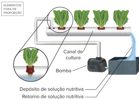
Representação do sistema de hidroponia.
