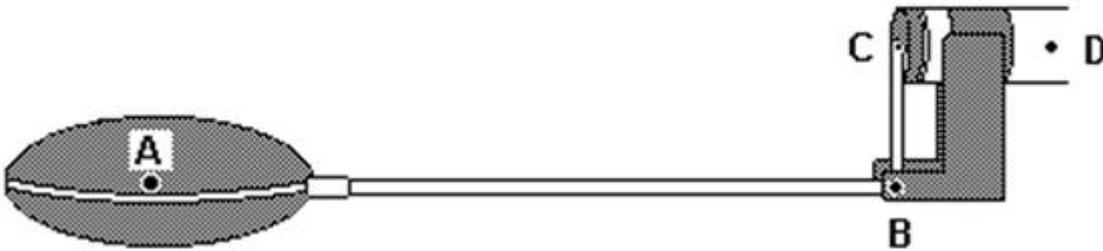
Considere que, em condições normais de funcionamento, uma boia mantenha a entrada de água fechada ao ter metade de seu volume submerso na água do reservatório. Uma vez que os braços AB e BC da alavanca em "L" guardam entre si a proporção de 5:1, a intensidade da força com que a alavanca empurra a válvula contra o cano, em N, é
