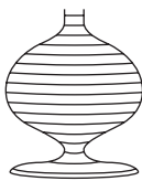
Figura 13-2: A base da lâmpada cortada em fatias finas e horizontais.
