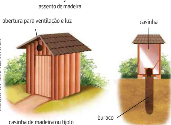
Figura 20.9 Construção de uma fossa seca. (Os elementos das ilustrações não estão na mesma escala; cores fantasia.)
