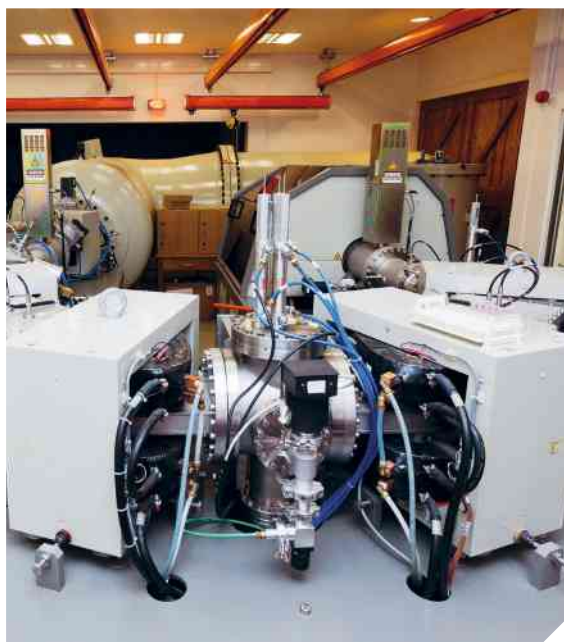
Figura 11.4 Equipamento que realiza a datação com carbono-14. Universidade de Oxford, Reino Unido. Foto de 2012.
