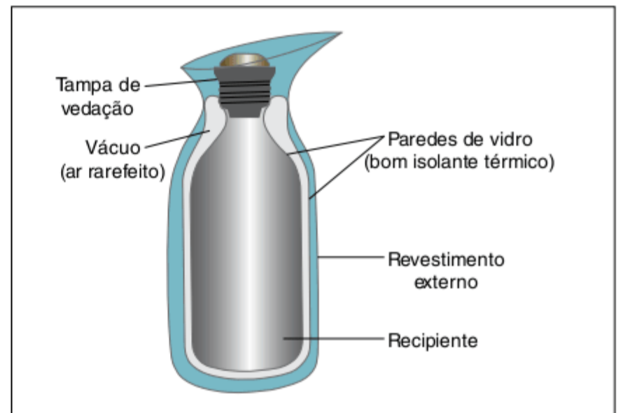
Fig. 19 Esquema de uma garrafa térmica.
