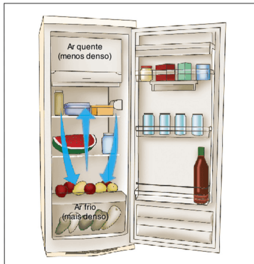
Fig. 11 Em uma geladeira, o fluxo de calor se dá graças às correntes de convecção, consequência da mudança de densidade do ar em seu interior.
