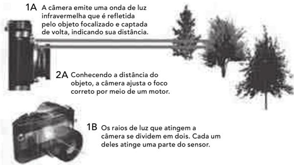
**1A** A câmera emite uma onda de luz infravermelha que é refletida pelo objeto focalizado e captada de volta, indicando sua distância.
