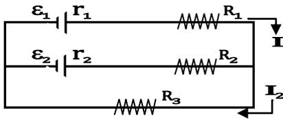
$$\begin{cases} \epsilon_1 - \epsilon_2 = (R_1 + R_2 + r_1 + r_2)I_1 - (R_2 + r_2)I_2 \\ \epsilon_2 = (R_2 + R_3 + r_2)I_2 - (R_2 + r_2)I_1 \end{cases}$$
