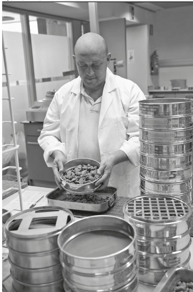
A granulometria é uma técnica utilizada para analisar solos e a qualidade de materiais como argamassa e cimento. Essa técnica consiste em verificar os diferentes tamanhos das partículas que constituem o material, sendo possível determinar a distribuição em porcentagem desses diversos tamanhos. No ensaio de granulometria, o material passa por um equipamento que apresenta várias malhas de aberturas específicas que retêm as partículas, separando-as. Esse método de separação é denominado
