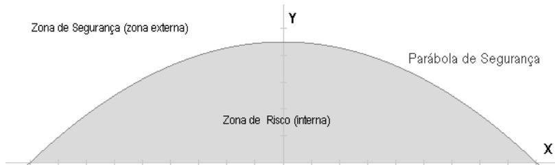
**Figura 3** - pontos localizados na zona externa à parábola de segurança (PS) não são alcançados por esse lançador, quando dispara projéteis com a velocidade  $V_0$  característica dessa PS.
