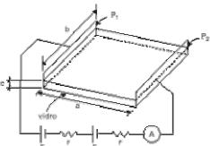
e que o amperímetro acusa uma corrente i = 0,10A, qual deve ser a espessura **e** do filme? (resistividade do alumínio  $\rho = 2,6 \times 10^{-8} \ \Omega.m$ ).
