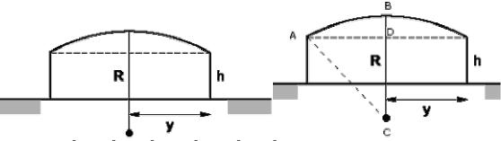
Solução: do triângulo ADC,  $DC^2 = AC^2 - AD^2 \rightarrow DC^2 = 39^2 - 25^2 = 896 \rightarrow DC = 29,9 m.$
