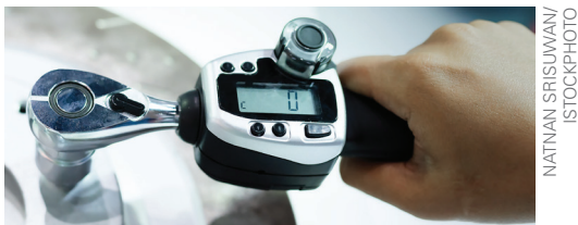
Torquímetro digital – medidor da grandeza vetorial torque.
