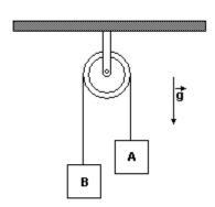
No arranjo experimental da figura, os corpos A e B têm massas, respectivamente, iguais a 2,0 kg e 3,0 kg. Despreze atritos e as massas do fio e da polia. Adote  $g = 10,0 \text{ m/s}^2$ .
