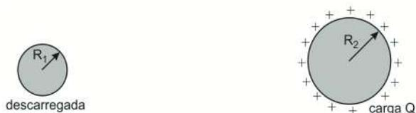
Em seguida, liga-se uma esfera à outra, por meio de um fio condutor longo, até que se estabeleça o equilíbrio eletrostático entre elas. Nesse processo, a carga elétrica total é conservada e o potencial elétrico em cada condutor esférico isolado descrito pela equação  $V = k.q/r$ , onde  $k$  é a constante de Coulomb,  $q$  é a sua carga elétrica e  $r$  o seu raio.
