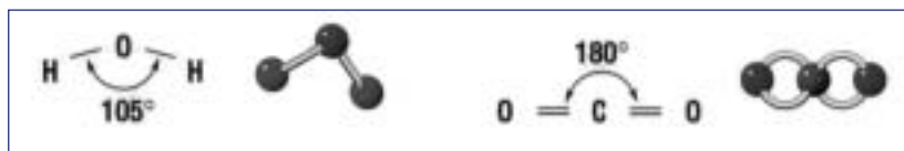
Figura 7: Geometria das Moléculas de água e dióxido de carbono.*
