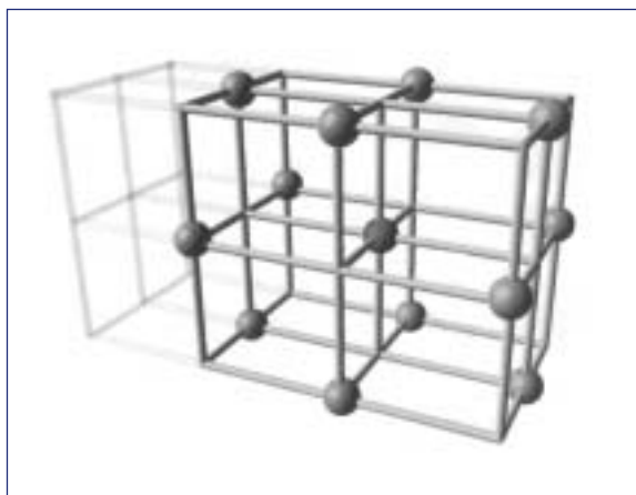
Figura 2: Geometria cúbica de face centrada – cada átomo é rodeado por outros doze átomos*
