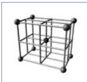
Figura 1: Geometria cúbica de corpo centrado – cada átomo é rodeado por outros oito átomos*
