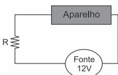
Considerando a corrente do circuito igual a 500 mA, qual deve ser o valor da resistência R, em  $\Omega$ , para que o aparelho não seja danificado?
