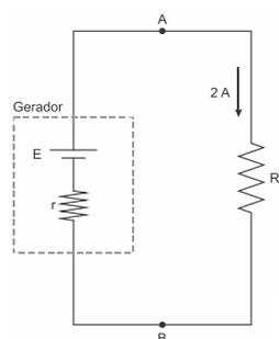
Considerando desprezíveis as resistências dos fios e das conexões utilizados na montagem desse circuito, os valores de  $E$  e de  $R$  são
