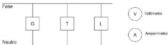
Para realizar essas medidas, o esquema da ligação desses instrumentos está representado em:
