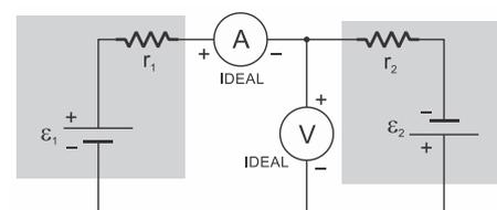
A figura acima mostra um circuito contendo dois geradores idênticos, sendo que cada um deles possui força eletromotriz de 10 V e resistência interna de 2,0  $\Omega$ . A corrente  $I$ , em amperes, medida pelo amperímetro ideal e a ddp, em volts, medida pelo voltímetro ideal, valem, respectivamente:
