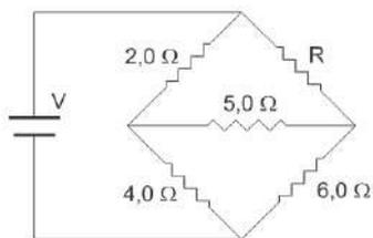
Determine, em  $\Omega$ , qual é o valor da resistência de  $R$  para que a corrente no resistor de  $5,0 \Omega$  seja nula.
