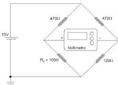
Para um valor de temperatura em que  $R_s = 100\Omega$ , a leitura apresentada pelo voltímetro será de
