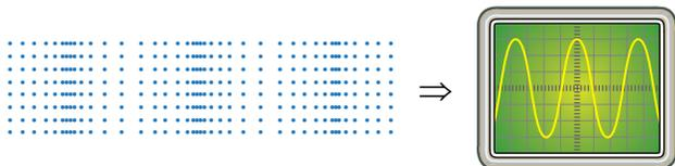
Veja que as compressões e rarefações da onda sonora são representadas no osciloscópio por cristas e por vales, respectivamente. Dessa forma, fazendo a leitura do aparelho, podemos determinar as grandezas características da onda sonora (período, frequência, velocidade, comprimento de onda e amplitude). Ou seja, o osciloscópio nos permite “visualizar” a onda sonora. Ao longo deste módulo, representaremos várias ondas sonoras conforme seriam vistas na tela do osciloscópio.
